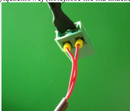
Podłączenie czujnika powrotu szuflady
