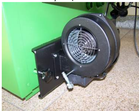
Montaż i podłączenie nadmuchu
